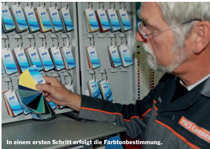
Funktioniert auch bei älteren Fahrzeugen oder solchen ohne Farbcode problemlos: das Zusammenspiel zwischen Farbtonmessgerät und Standoblue.
